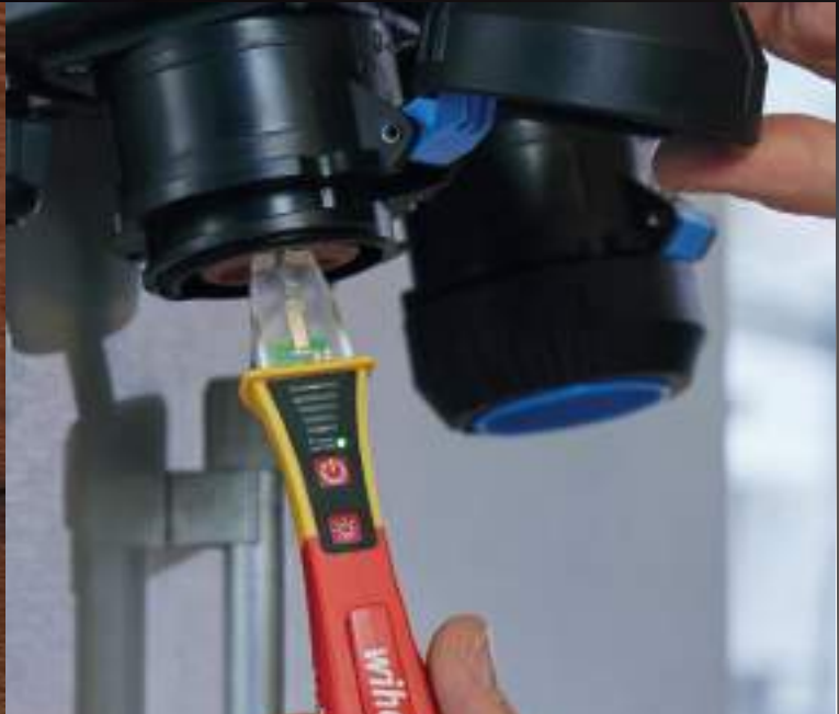
International angepasste Messspitze für alle Steckdosen weltweit
