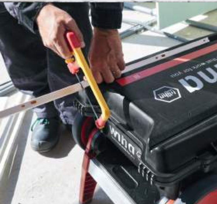
V-förmige Kerbung mit Skala im Kofferdeckel
